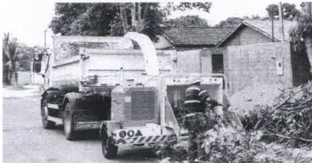
Figura 18 – Triturador de galhos e poda acoplado em caminhão
